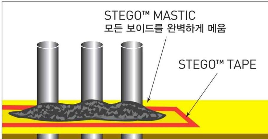
주의 : 설치 지침은 ASTM E 1643 슬래브 하부 토양 및 그래놀라 필과 직접 접촉하는 부분에 적용되는 방습층 선정, 설계, 설치 및 검사에 대한 기준을 바탕으로 한다.
